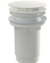
A396B Výpust umyvadlová 5/4" celokovová, velká zátka, pro umyvadla bez přepadu, bílá-lesk
